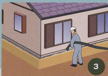
コンクリートを打ち増し
